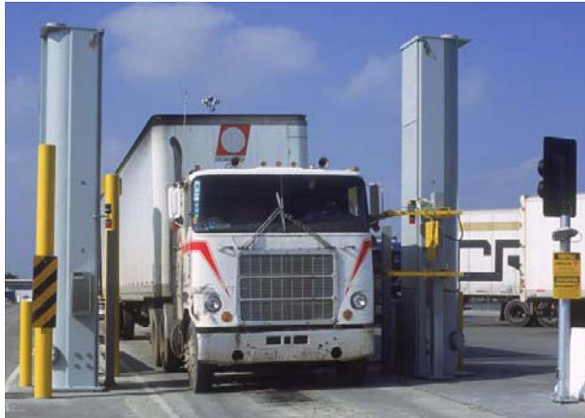
Fotografía 5.1 Modulo de inspección con rayos gamma
